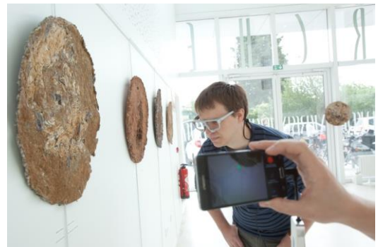
Utilisation d'un « eye-tracker » mobile sous forme de lunettes. Les mouvements oculaires sont suivis par le point vert sur l'écran de smartphone. © Frédéric MALIGNE/MSH Toulouse/CNRS Photothèque
